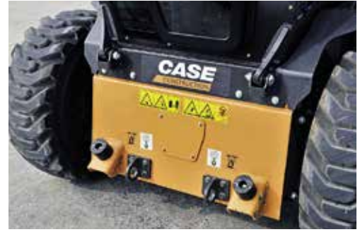
Őasi üzerindeki kauçuk takozlar itme gücünü destekler!
